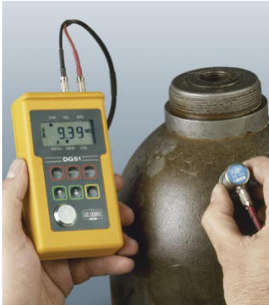
DG 51 B è uno spessorimetro ultrasonoro di ultima generazione, caratterizzato da peso e dimensioni contenute, grande autonomia ed elevata affidabilità. DG 51 B opera con una ampia gamma di sonde doppie e propone l'autocalibrazione attraverso il riconoscimento automatico della sonda collegata, un'ampia regolazione del guadagno e la possibilità di registrare i dati e rileggerli sul display.
